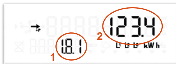
Abbildung 1 - Display - Wirkenergie Bezug "1.8.1"
